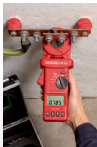
Meting van de aardlusweerstand van een systeemaardelektrode
