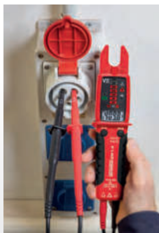
spanningsmeting en draaiveldrichtingstest
